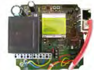
NDA008 VERSTÄRKERMODUL IN EINEM KUNSTSTOFFGEHÄUSE
