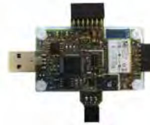
NDA004 PROGRAMMIERUNGS- UND INSTALLATIONSMODUL
