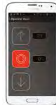
APP FÜR DIE PROGRAMMIERUNG DES STEUERGERÄTS ÜBER ANDROID SMARTPHONE ODER TABLET MITTELS BLUETOOTH.
