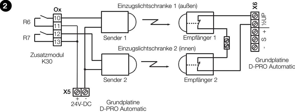
**ACHTUNG:** Wenn 2 Lichtschranken als Einzugssicherung verwendet werden, dann müssen die Relaiskontakte (Öffner) der Empfänger in Serie geschaltet und an der Klemme J33 auf der Grundplatte der Torsteuerung D-PRO Automatic angeschlossen werden.
